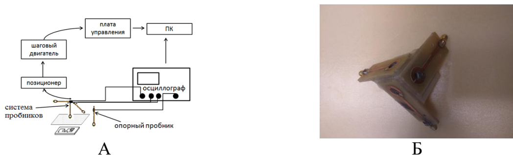
Рисунок 6. А) Схема экспериментальной установки, Б) Система 3-х взаимно-перпендикулярных пробников
