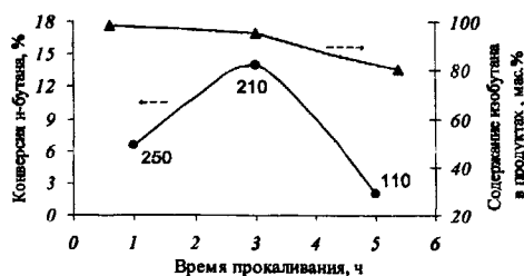
Рис. 9. Зависимость конверсии н-бутана на образце Pt-6э(III) (16 мас. % WO_3 , 1 мас. % Pt) от времени прокаливания 6э(III) при 820°C.
