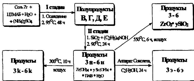
Рис.6. Схема приготовления образцов для их дальнейшего модифицирования
