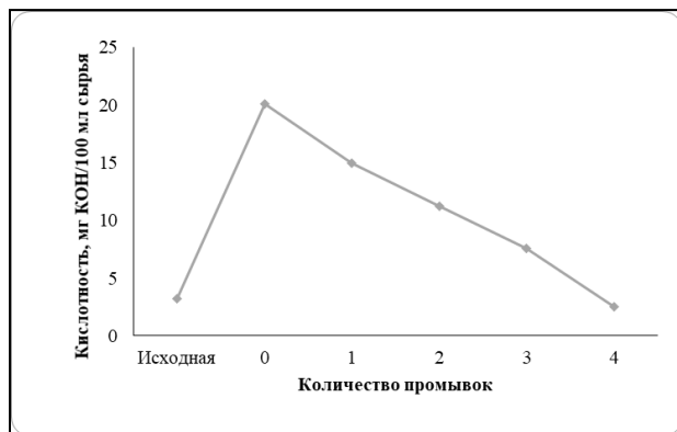
Рисунок 7. Зависимость изменения кислотности бензиновой фракции от количества промывок.
