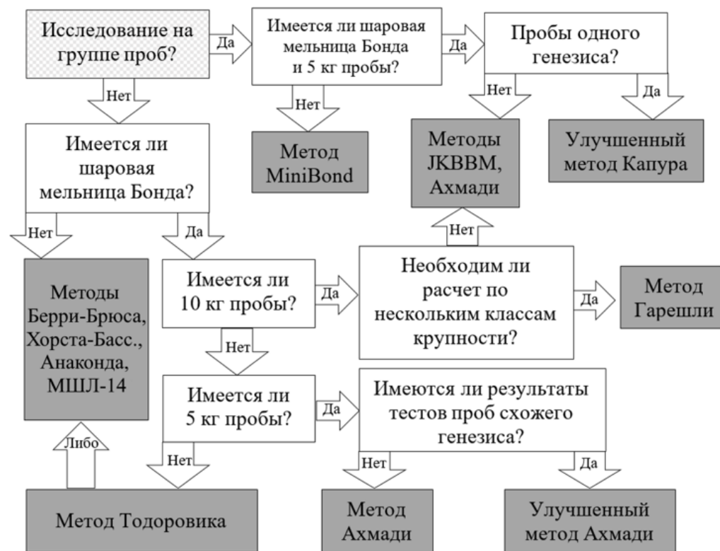
Рисунок 2 – Блок-схема выбора альтернативной методики определения рабочего индекса шарового измельчения Бонда
