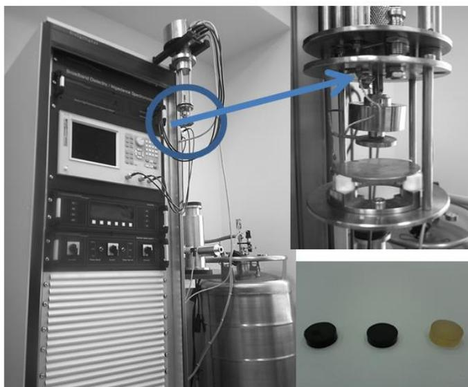
Фото 1. Изображение диэлектрического спектрометра (novocontrol concept 80), измерительной ячейки (конденсатора) и полимерных композиционных образцов с добавкой УНТ различной концентрации
