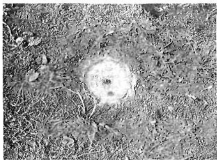
Рисунок 3 – Закрепление точек полигона
