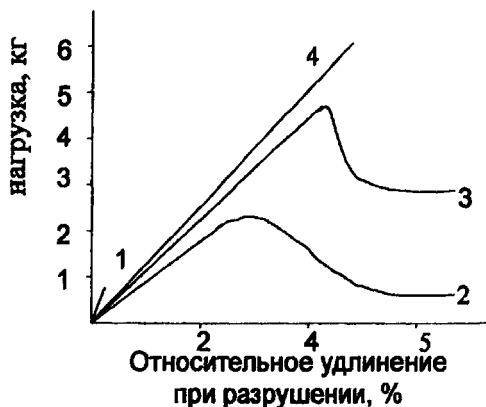
Рис. 6. Типичные кривые разрушения волоконного световода с различными полимерными защитно-упрочняющими покрытиями: 1 - Кварцевое оптическое волокно; 2 - ВС, покрытый термоотверждаемым эластомером марки Sylgard-182; 3 - ВС, покрытый фотополимеризуемым полимером марки Desoto 950X131; 4 - ВС, покрытый фотополимеризуемым эпоксиакрилатным полимером на основе ЭД-16-АК. Длина образцов 50см, скорость деформации - 7 мм/мин.
