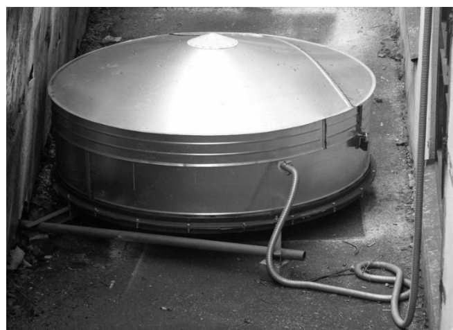
Рис. 2. Мультисекторный сцинтилляционный детектор для эксперимента БАРС-ШАЛ.
