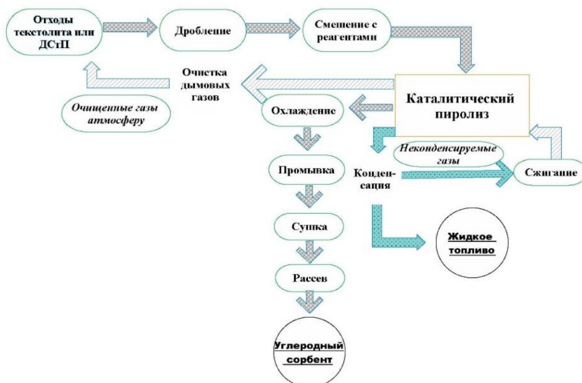
Рисунок 6 – Операционная модель термокатализической переработки полимерных отходов текстолита и ДСтП
