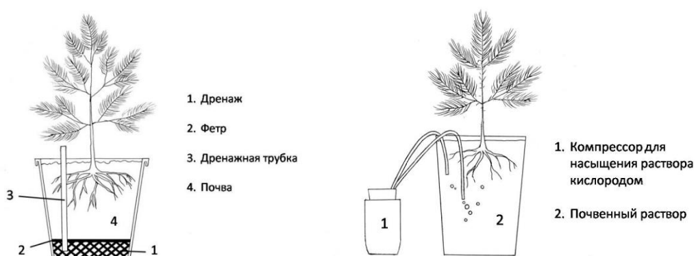
Рис. 1. Схема конструкции модельного эксперимента с почвенной (слева) и водной культурами (справа) сосны обыкновенной.
