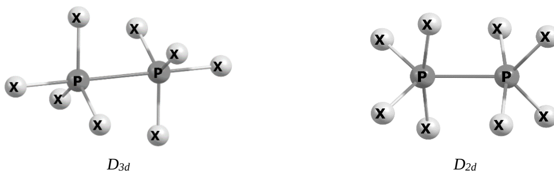
Рис. 4 – Структурные изомеры молекулярной системы P_nX_{3n+2} , ( X : F или Cl, n = 2 ). D_{3d} – связь P–P в аксиальном положении, D_{2d} – связь P–P в экваториальном положении.
