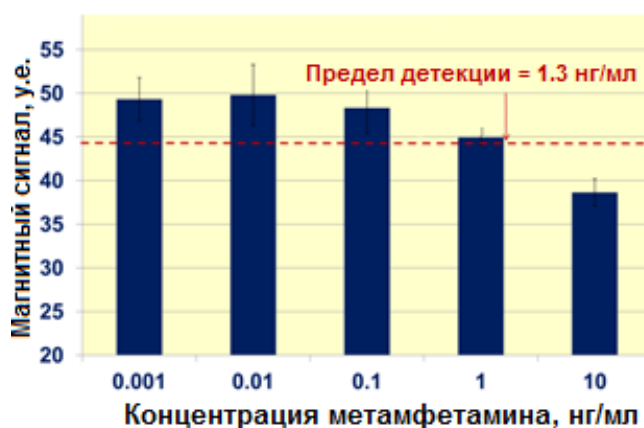
Рисунок 11 - Зависимость сигнала магнетометра от концентрации метамфетамина. Красная пунктирная линия показывает пороговое значение, вычисленное по критерию 2\sigma (отрицательный контроль минус двойное относительное стандартное отклонение)
