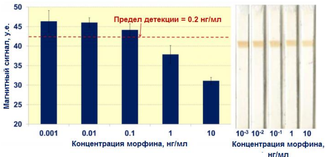
Рисунок 10 - Зависимость сигнала магнетометра от концентрации морфина. Красная пунктирная линия показывает пороговое значение, вычисленное по критерию 2\sigma (отрицательный контроль минус двойное относительное стандартное отклонение)
