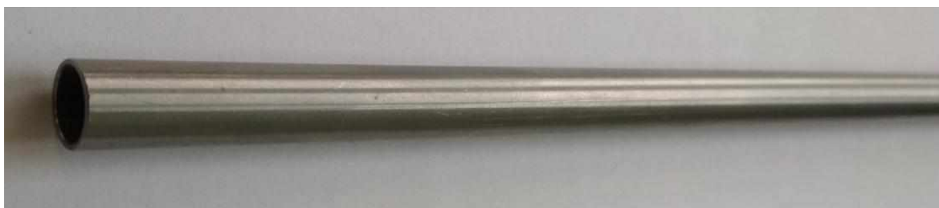
Рисунок 17 – Внешний вид оболочки твэла Ø9,10×7,73×4130 мм из сплава Э110 с содержанием фтора менее 1 ppm
