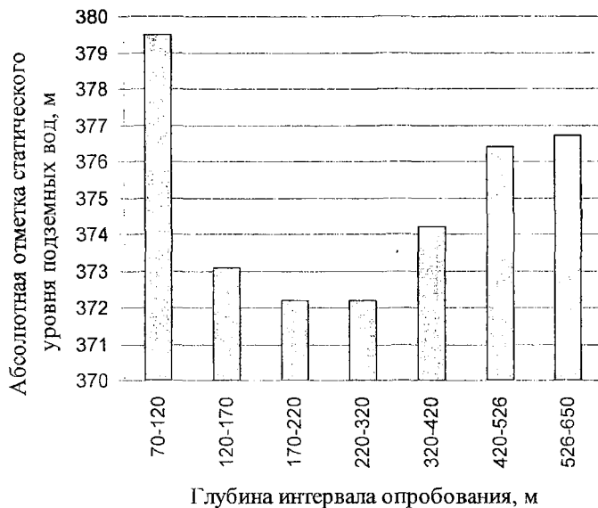
Рис. 3. Изменение напоров подземных вод по интервалам опробования палеозойского водоносного комплекса (скв. 3Ю)
