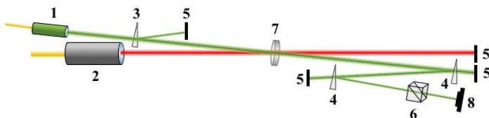
Рис. 5. Схема эксперимента по измерению параметра оптической анизотропии кристаллов: 1 – источник пробного излучения, 2 – Yb: fiber лазер, 3 – шпатовый клин, 4 – кварцевый клин, 5 – поглотитель излучения, 6 – призма Глана, 7 – исследуемый образец, 8 – CCD-камера.
