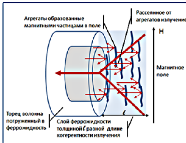
Рис. 5. Формирование магнитооптического отклика от торца волокна.
