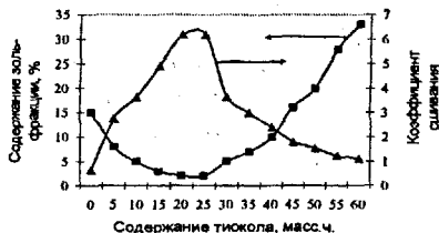
Рис. 12. Влияние содержания тиокола марки П на содержание золь-фракции и коэффициент сшивания материалов на основе ПН-9119.
