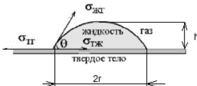
Рисунок 11 - Капля на твердой поверхности монокристалла
