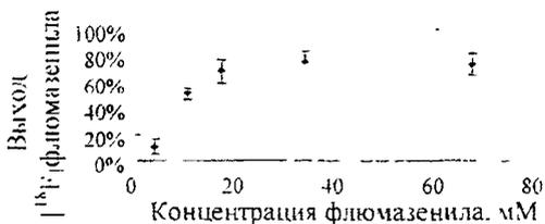
Рис. 6. Зависимость выхода  $[^{18}\text{F}]$ флюмазенила от концентрации флюмазенила (ДМФ  $T=160^\circ\text{C}$   $C_{\text{ГЛЧ}}=30$  мМ, время реакции 15 мин ( $n>5$ ))
