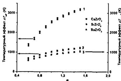
Рисунок 8 – Зависимость  $\Delta T_{ад}$  и  $\Delta T_{макс}$  для SCS  $MZrO_3$  ( $M = Ca, Sr, Ba$ ) от  $\varphi$ : 1 – расчет из стандартных значений теплоемкостей и энтальпии, 2 – расчет с учетом температурных зависимостей теплоемкостей и энтальпии, 3 – расчет с дополнительным учетом потерь теплоты на расширение газов
