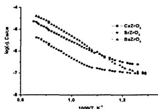
Рисунок 5 – Высокотемпературные электропроводности  $\text{CaZrO}_3$ ,  $\text{SrZrO}_3$  и  $\text{BaZrO}_3$  на воздухе
