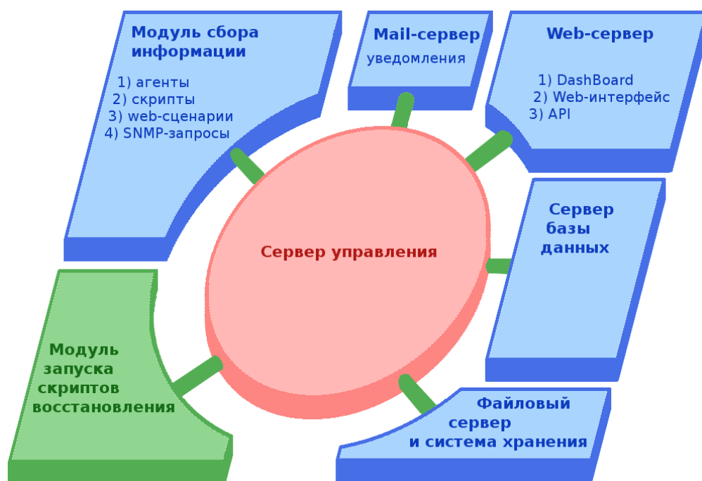
Рис. 2. Компоненты основного сервера Центра оперативного контроля Глобальной сети телескопов-роботов МАСТЕР
