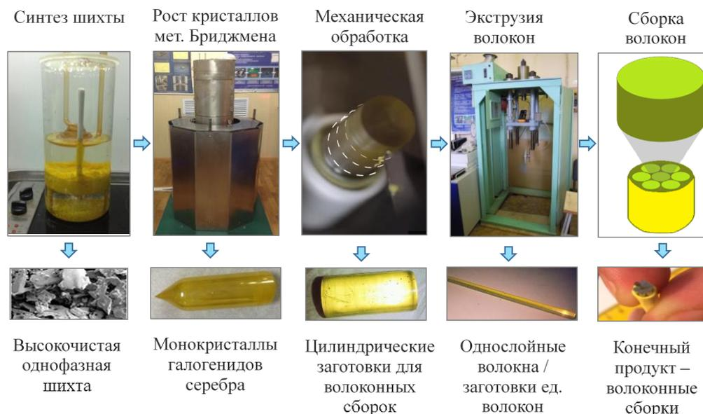
Рисунок 5 – Производственный цикл изготовления волоконных сборок
