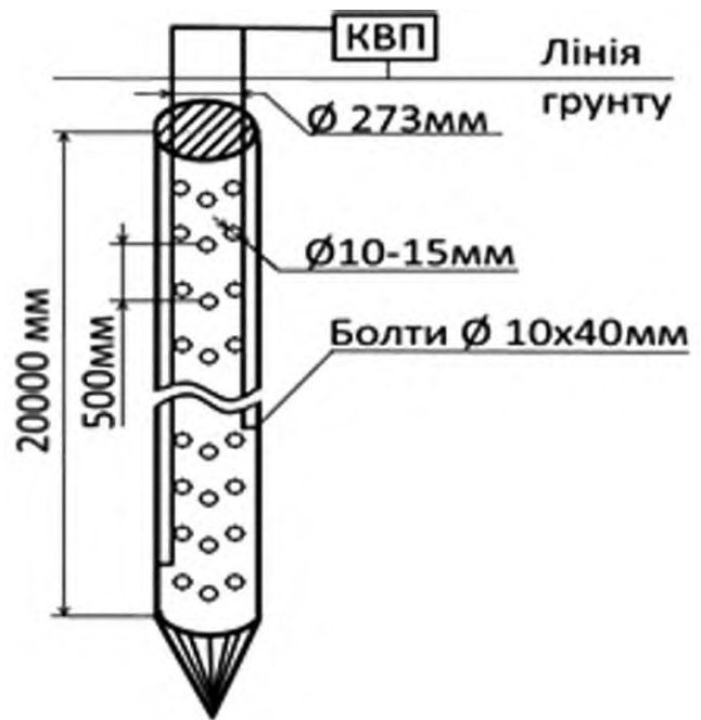
Рис. 7. Конструкція глибинного анодного заземлювача Ду 273 мм.
