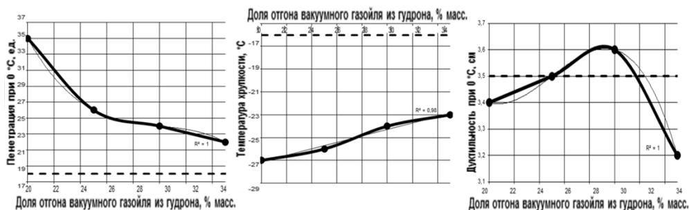
Рисунок 2 – Зависимости пенетрации и дуктильности при 0°C, а также температуры хрупкости от глубины отбора вакуумного газойля из гудрона
