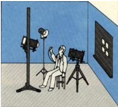
Рис. 115 Изображение отражается в объективе увеличителя, вставленном в павильонный фотоаппарат 9x12. Пол О'Кейн применил здесь студийную вспышку и естественный свет. Из черной бумаги он вырезал оконный переплет и занавесил им окно (см. рис. снизу). Товарищ помог ему навести камеру на фокус. Когда все было готово, фотограф занял свое место и привел в действие камеру и вспышку посредством тросика. "Де Вере" 5x4, 150 мм, 1 с., диафрагма 16.
